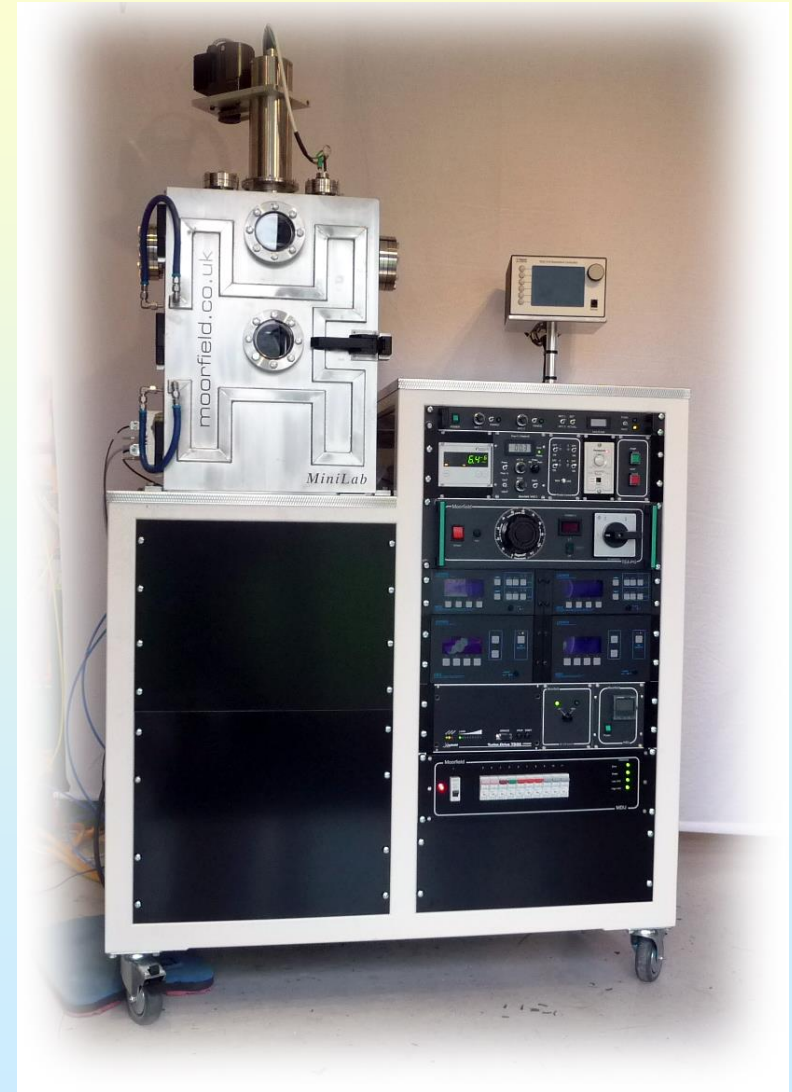
Вакуумная универсальная автоматическая система для нанесения тонких пленок Moorfield MiniLab-080
