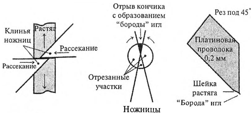
Рис. 18. Процесс рассекания—растяга при обрезании иглы [6]
