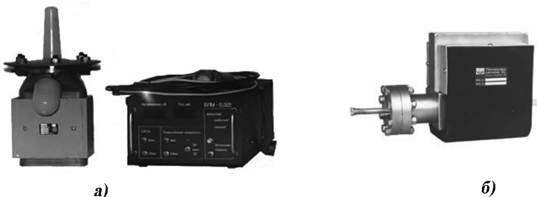
Рис. 1.61. Внешний вид отечественного магниторазрядного диодного насоса НМДИ-0,025 (а) (наибольшая быстрота действия, л/с ( \pm 20\% ): по азоту — 20, по аргону — 5; предельное давление — 2 \cdot 10^{-9} Торр), магниторазрядного диодного насоса компании Hositrad HP-020 (б) (скорость откачки — 20 л/с, предельное давление — 10^{-11} Торр)
