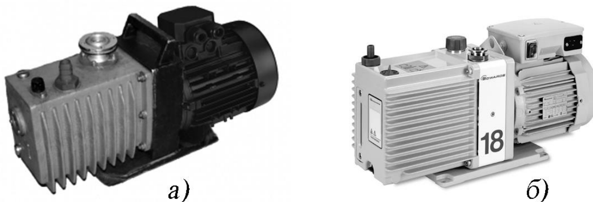
Рис. 1.13. Внешний вид отечественного пластинчато-роторного насоса 2НВР-5дм (а) (скорость откачки — 5,5 л/сек, предельное давление — 5 \cdot 10^{-3} Торр) и пластинчато-роторного насоса компании Edwards E2M18 (б) (скорость откачки — 20,5 л/сек, предельное давление — 7,5 \cdot 10^{-4} Торр)
