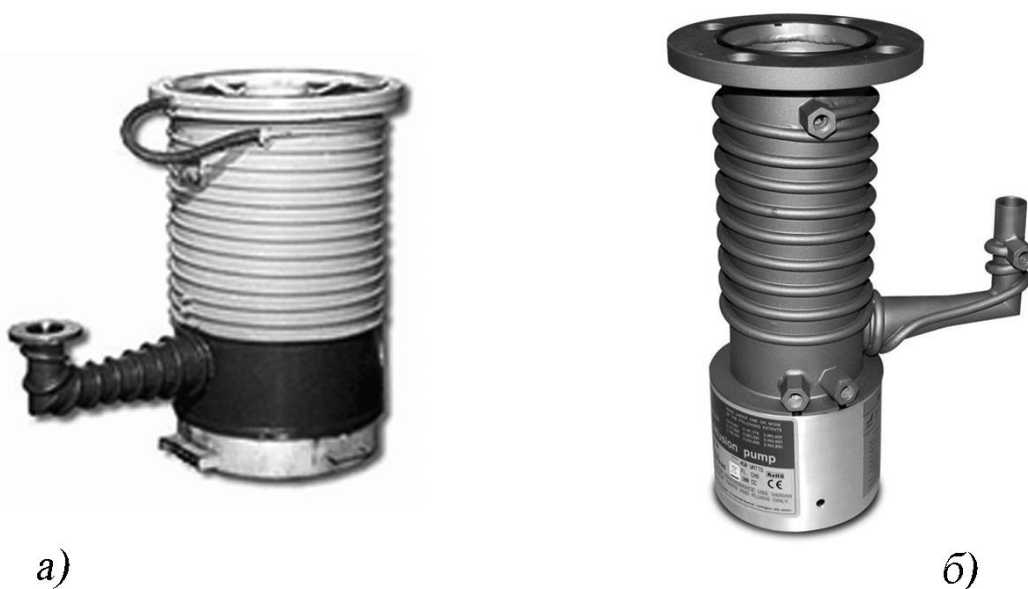
Рис. 1.49. Внешний вид отечественного диффузионного насоса компании «Гидромех» НВДМ-100 (а) (скорость откачки — 340 л/с, предельное давление — 6,6 \cdot 10^{-7} Торр), диффузионного насоса компании Varian HS2 (б) (скорость откачки — 340 л/с, предельное давление — 5 \cdot 10^{-8} Торр)
