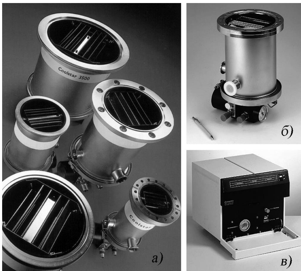
Рис. 1.53. Криогенные насосы модели CoolStar компании Ricor (а); CoolStar 3000 (б); скорость откачки, л/с: по \text{H}_2\text{O} — 9500, \text{N}_2 — 4500, \text{H}_2 — 3500, \text{Ar} — 2800; гелиевый компрессор (в)
