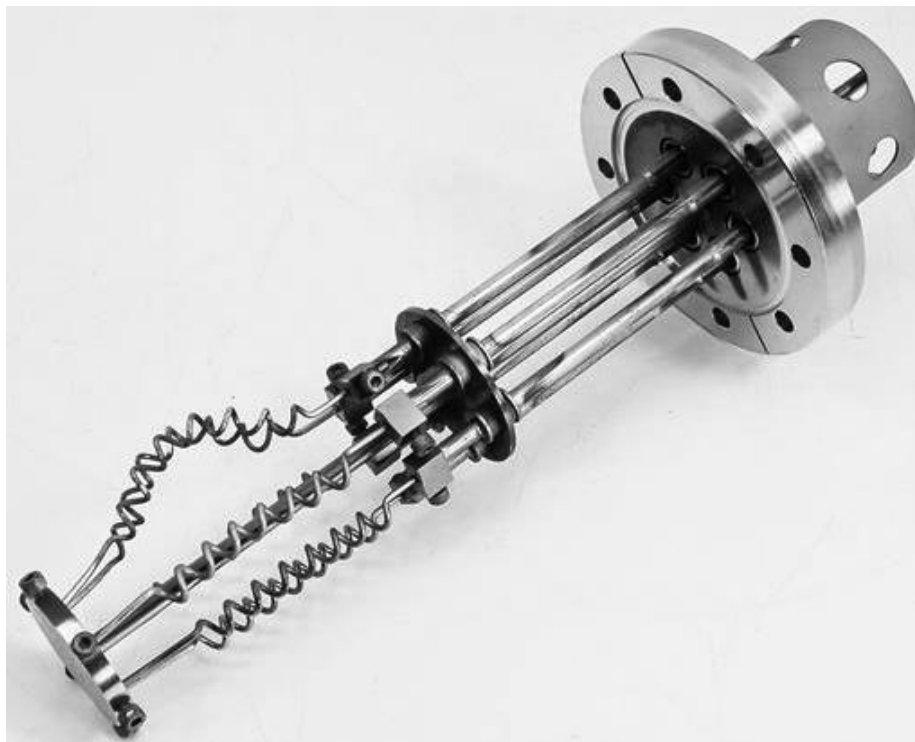
Рис.1.55. Сублимационный титановый вакуумный насос компании Vacom. Максимальная скорость откачки (л/с на см 2 ) пленки титана при температуре 300/77 К: H 2 — 2,6/17; D 2 — 3,1/6,2; H 2 O — 7,3/14,6; CO — 8,2/11; N 2 — 3,5/8,2; O 2 — 8,7/11; CO 2 — 4,4/9,3
